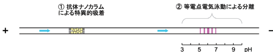
図2 ナノ・イムノCIEFは生体試料中に含まれる20ngのタンパク質の等電点分析が可能です。
