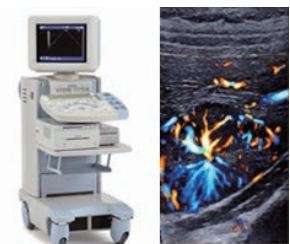
超音波画像診断装置： 筋の力学的特性(弾性)イメージング可能
