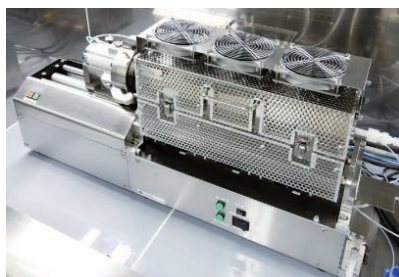
^{211}\text{At} 乾式分離精製装置 ターゲット中に生成したアスタチン-211を加熱して効率よく取り出す装置。
