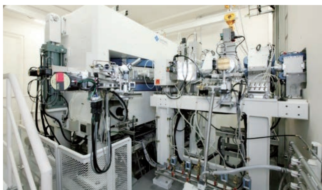
中型サイクロトロンMP-30 陽子、重陽子、ヘリウム原子核を加速する装置。医療機関に設置されたこのサイズのRI製造用のサイクロトロンは福島県立医大のものが国内唯一です。ヘリウム原子核をビスマスに照射して核反応させ、アルファ線を放出する半減期7.2時間のアスタチン-211を作り出すことができます。
